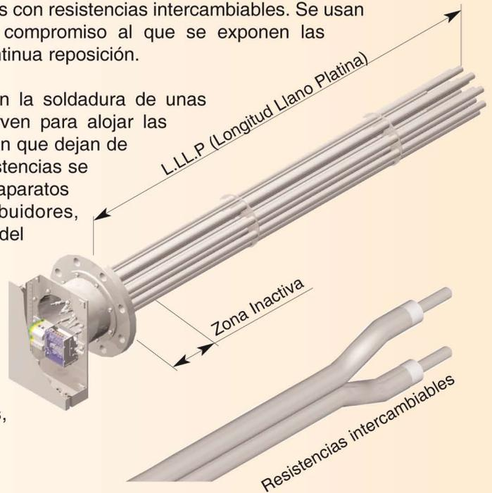
**DETALLE CONSTRUCCIÓN DE BRIDAS CON RESISTÉNCIAS INTERCAMBIABLES**
