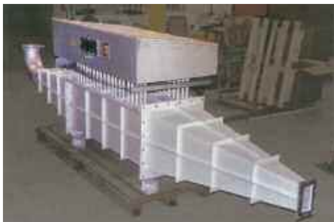
Duct heater for testing propellers Batteries chauffante pour essais de propulseurs
