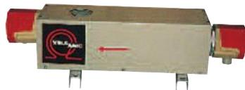
Permettent le chauffage de l'eau, du fioul ou de l'huile en circulation jusqu'à 15 bar dans une tuyauterie. Ils sont constitués de 1, 2 ou 4 corps DN 80 en acier peint ou inox 304L, de thermoplongeurs à visser M77 et d'un thermostat de sécurité fixe à réarmement automatique 115°C pour l'eau et ajustable de 0 à 300°C pour l'huile.
